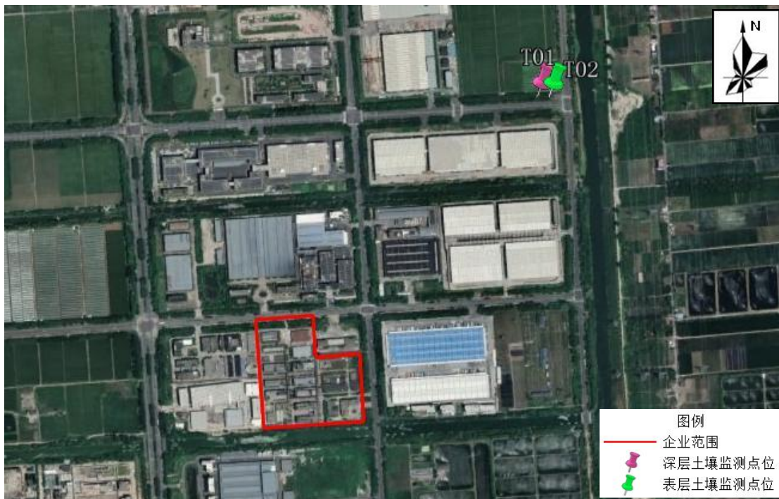
图 4.1-5 企业自行监测对照点土壤监测点布设图
