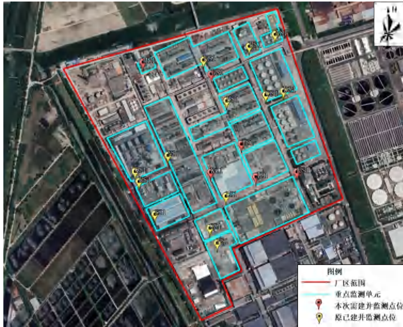
图 6.1-2 浙江巴陵恒逸己内酰胺有限责任公司老厂区地下水监测点位布设图
