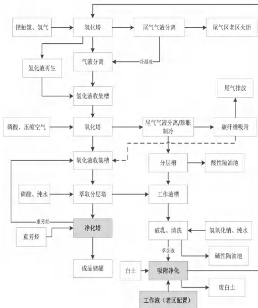
图 4.1-14 新厂区双氧水装置工艺流程图
