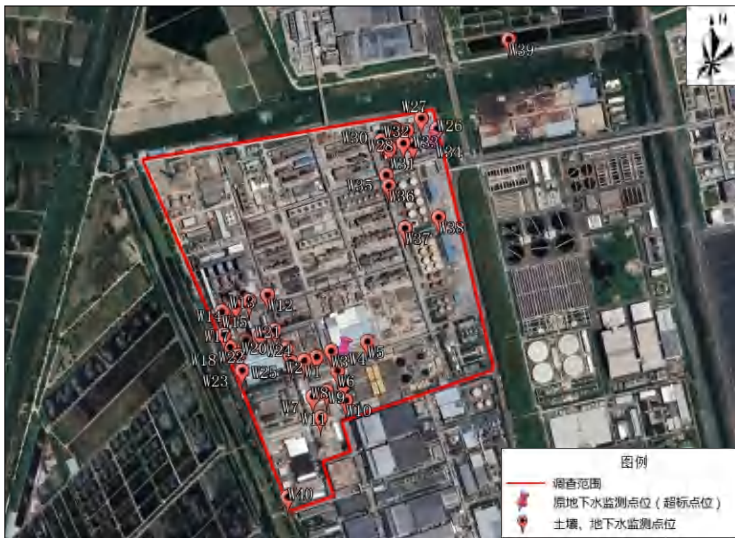
图2.3-2 地下水及土壤采样点位图
