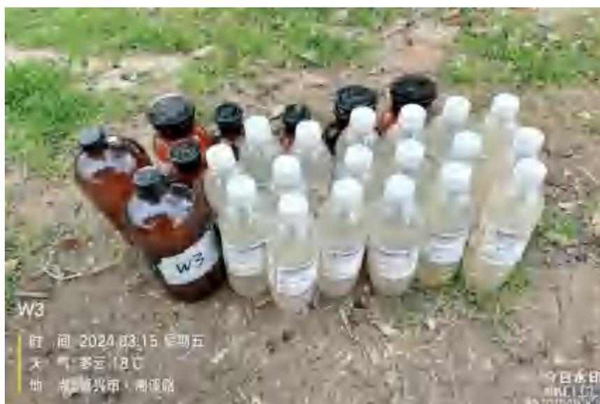
图 5.2-8 地下水分装样品及标签照片
