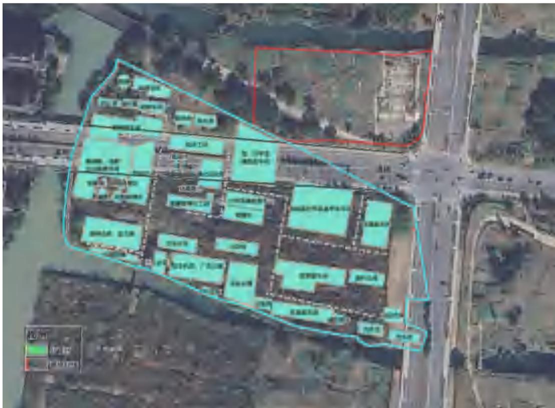
图 3.6-6 硫酸分厂厂区污水管线图及硫酸分厂与本地块的相对位置
