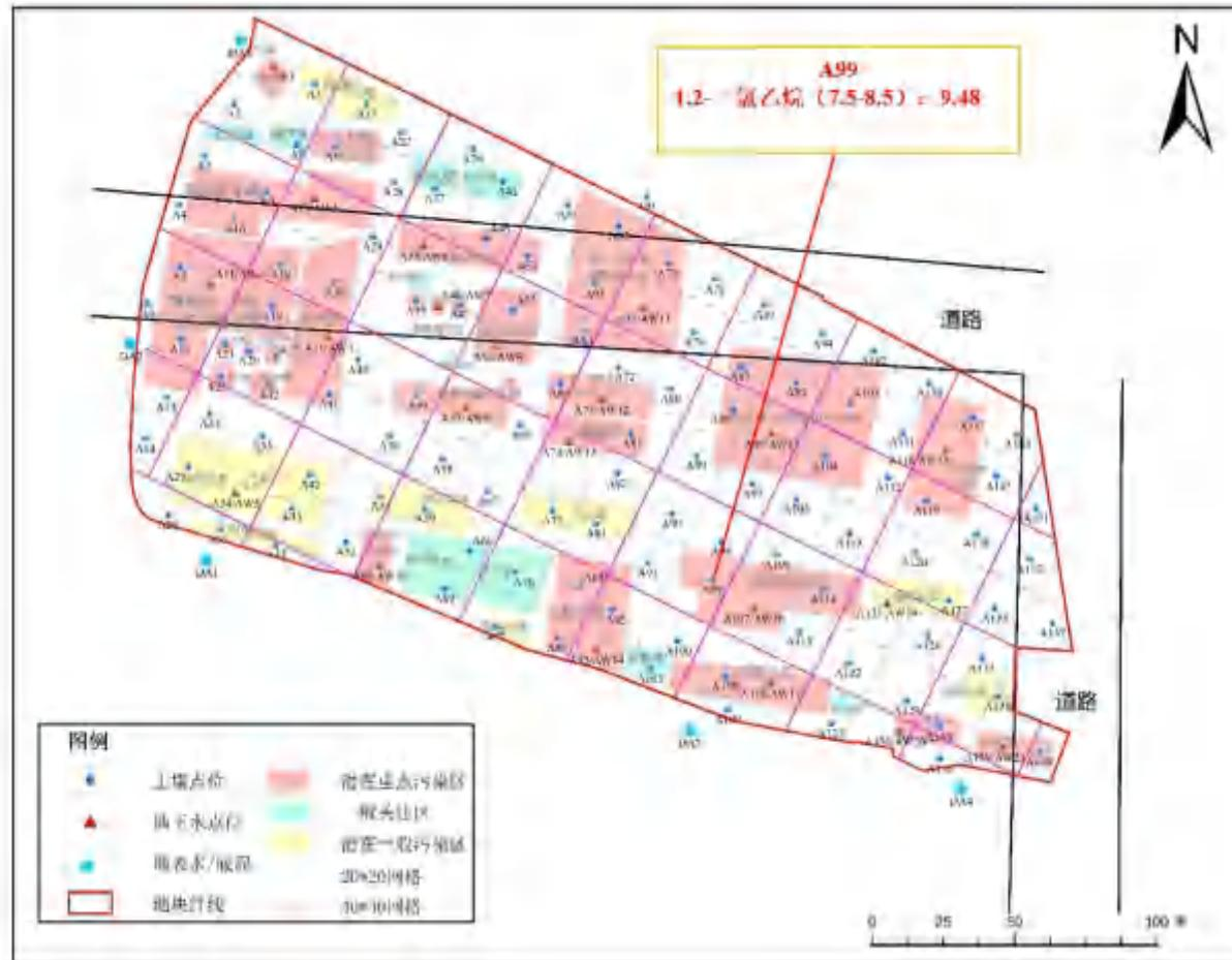
图 3.6-22 嘉兴化工集团硫酸分厂地块土壤超第一类用地/敏感用地管制值指标分布图
