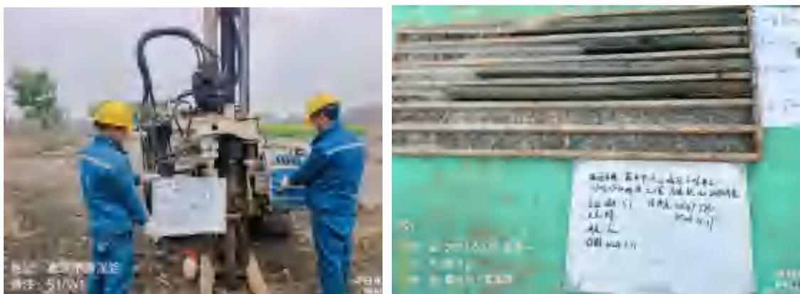
图5.2-1 土壤钻探取样现场照片
