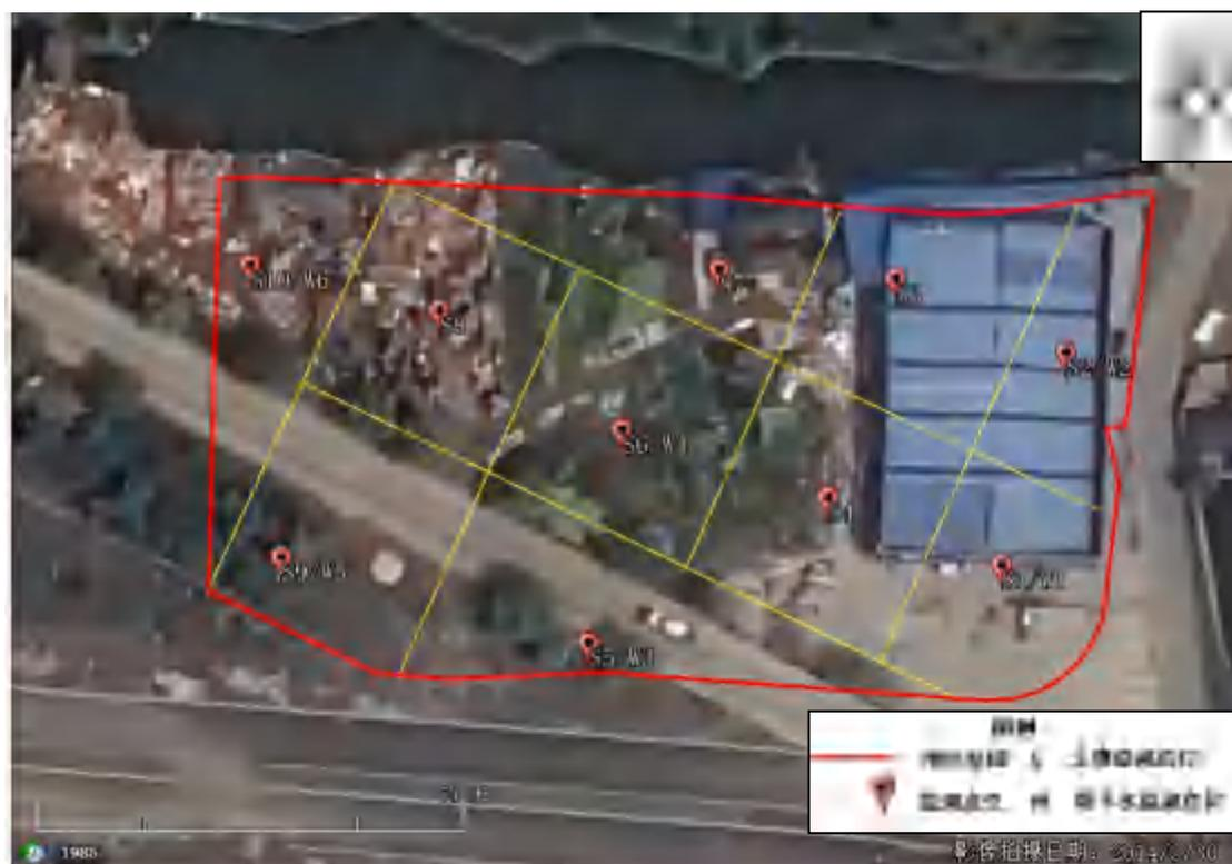
图 4.2-3 本次地块调查土壤及地下水采样点位布设图（地块内 2014 年 3 月影像图）
